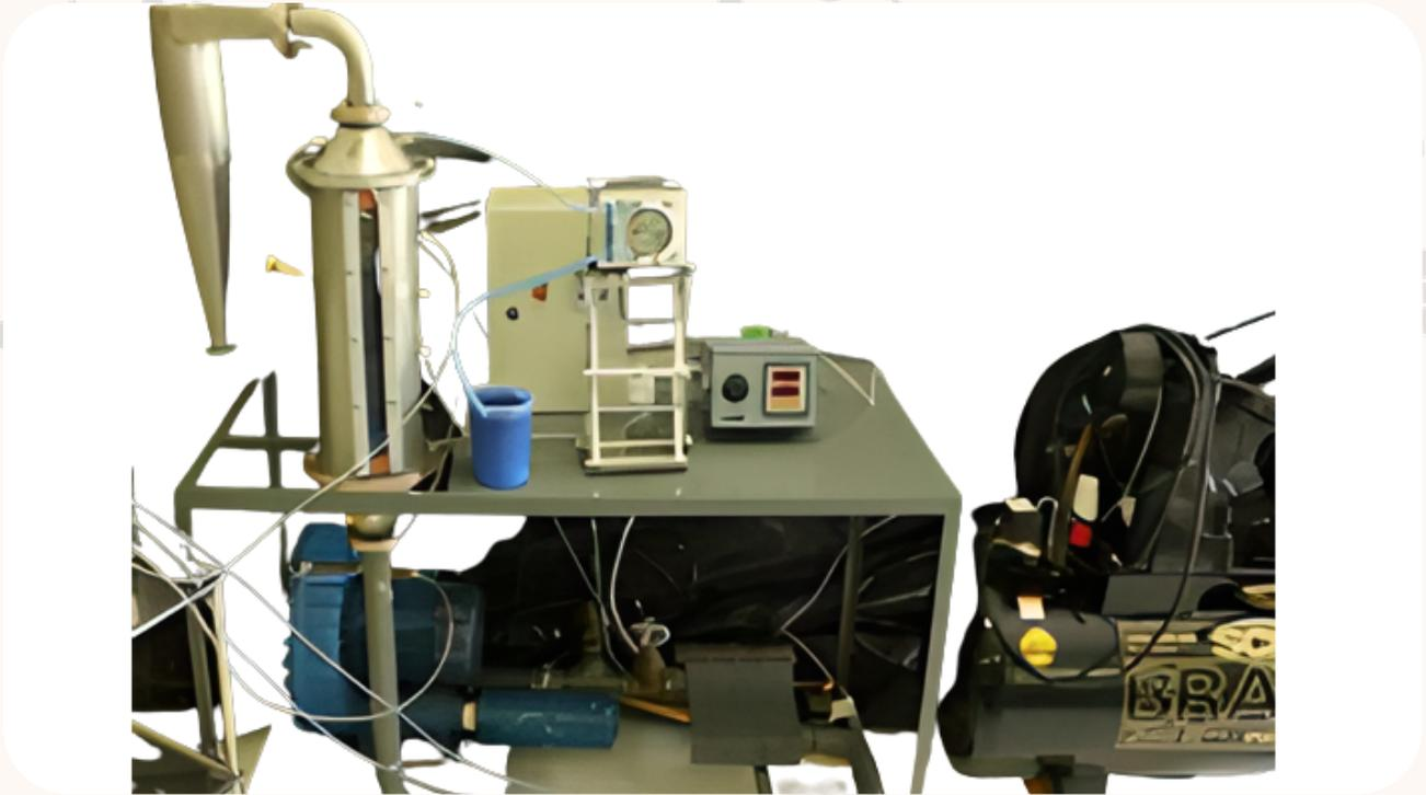
Figura 1: Leito de Jorro Aplicado em Recobrimento de Partículas.
