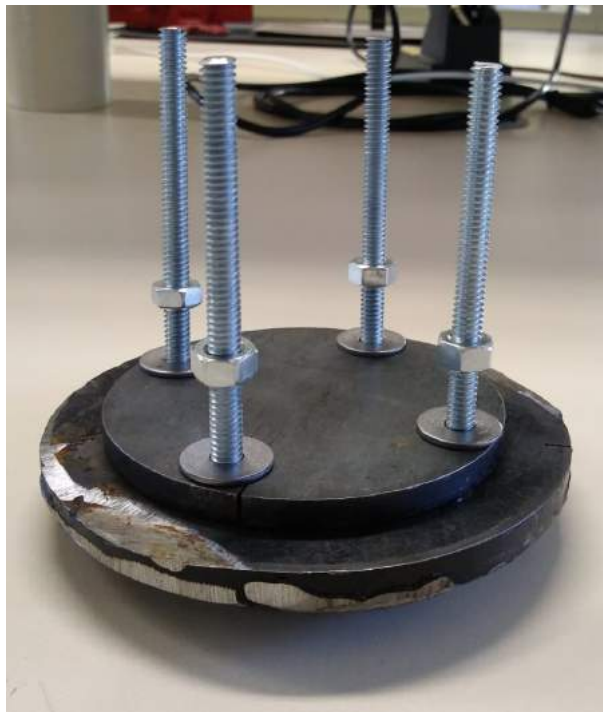
Figura 58 – Aparato construído para pressionar o protótipo.
