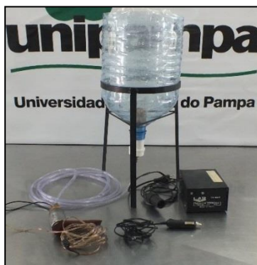
Figura 3: Incubadora Portátil NUPI 12 V e seus principais componentes.
