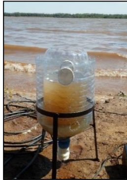
Figura 4: Incubadora NUPI 12 instalada como Laboratório móvel nas margens do rio Uruguai.
