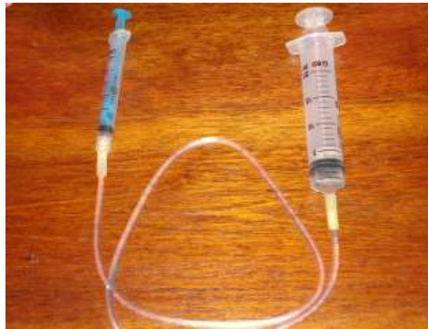
Figura 2 – Mostra duas seringas utilizadas como pistões na prensa hidráulica.
