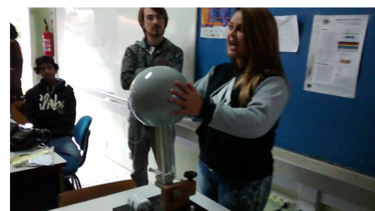
Figura 4: Aluna no gerador de Van de Graaff.
