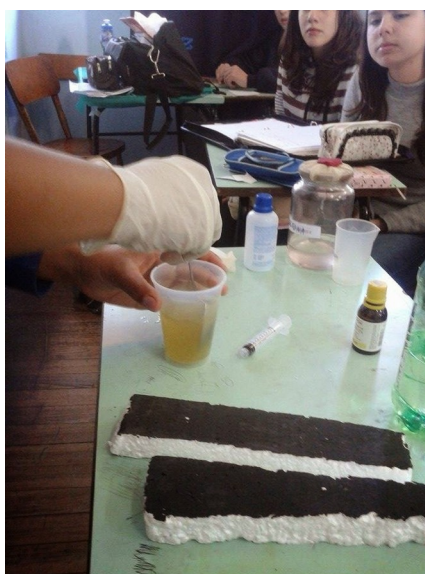
Figura 2. Demonstração do derretimento do isopor com acetona pura
