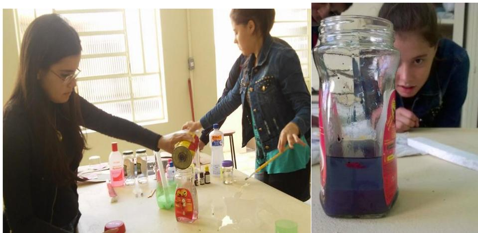
Fig. 5- Os clubistas testando e obtendo a mistura final. Na parte superior: Acetona pura + Aguaraz; Na parte inferior: Água+ álcool + corante.
