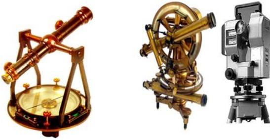
Ao longo dos anos foi sendo transformado e a ele agregados sistemas e mecanismos que o tornaram mais preciso em suas medições. O teodolito é um instrumento ótico utilizado para medir ângulos, tanto horizontais como verticais, em medidas diretas e indiretas de distâncias.
