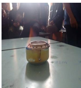
Figura 3 - Fogareiro aceso final: Com buracos maiores para entrada de oxigênio
