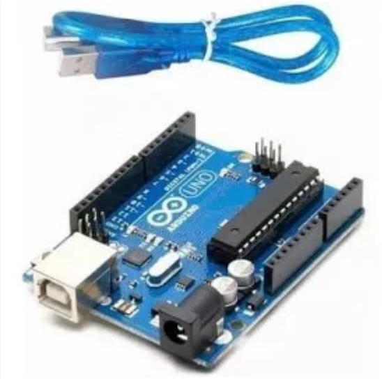
Fig 13. Placa Arduino que compõe o KIT (Modelo UNO)
