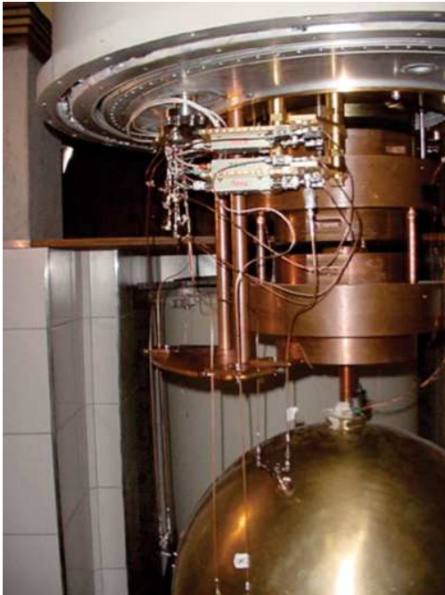
Figura 27: Foto do detector Mario Schenberg, localizado no estado de São Paulo. Acima da esfera pode-se ver o sistema de massas que diminuem a vibração do sistema.
