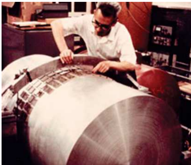
Figura 26: Joseph Weber acreditou ter detectado a passagem de uma onda gravitacional com sua barra ressonante coberta de detectores.
