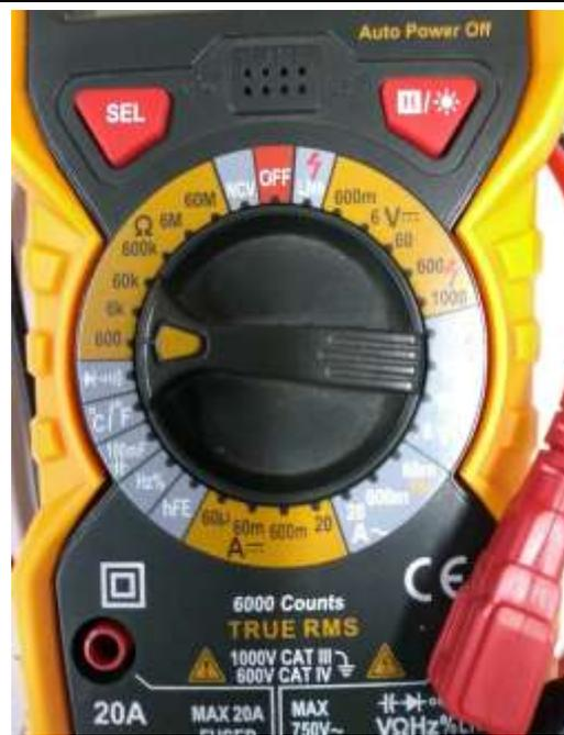
Utilizando um multímetro com alimentação mínima de 9 V, como por exemplo o mostrado na Figura 1, dispendo de múltiplas escalas de resistência elétrica, conforme Figura 2, procede-se a medição do isolamento entre fases, neutro e terra junto ao disjuntor geral desenergizado.
