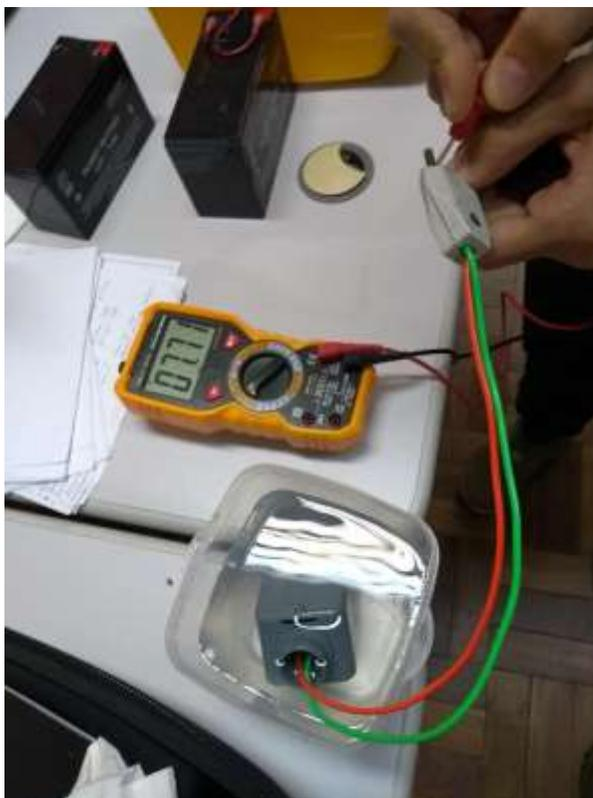
Figura 4: Isolamento Elétrico ( $3,22 \text{ G}\Omega$ ) medido em uma tomada úmida
