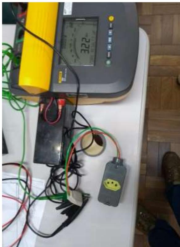
Figura 5: Isolamento Elétrico ( $380 \text{ G}\Omega$ ) medido em uma tomada completamente seca
