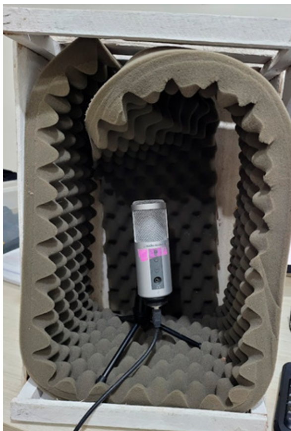
Sugestão de montagem do microfone em uma caixa com espuma para minimizar o eco
