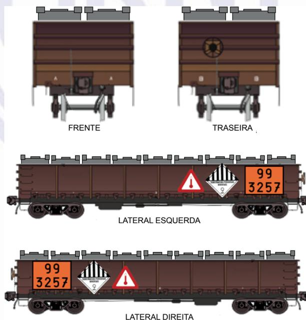
Figura S.14 – Transporte ferroviário de carga fracionada de um produto transportado à temperatura elevada (ver 13.5)
