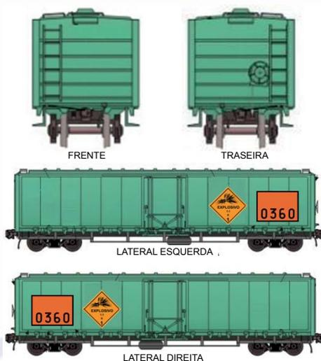
Figura S.15 – Transporte ferroviário de carga fracionada de um único artigo ou substância da classe 1 (explosivo) (ver 14.1)
